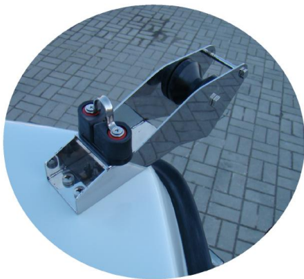
winda kotwiczna (rolka) INOX dziobowa/duża z knagą samozaciskową i uchem INOX
