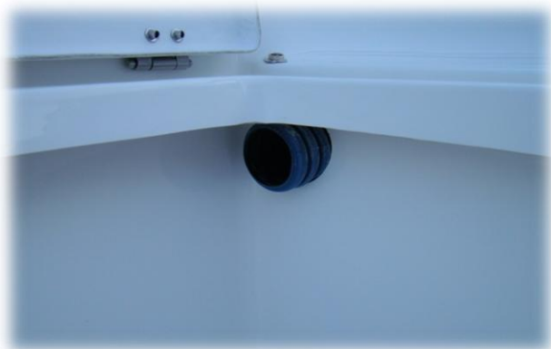
system kanałów do przeprowadzenia linii paliwowej lub przewodów elektrycznych pomiędzy schowkami
