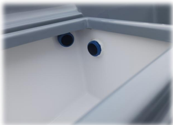
wyście do echosondy oraz kanały do przeprowadzenia przewodów
