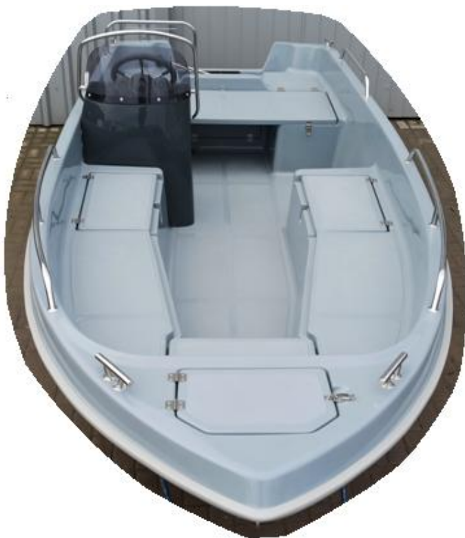
luk holta do montażu silnika na dziobie
