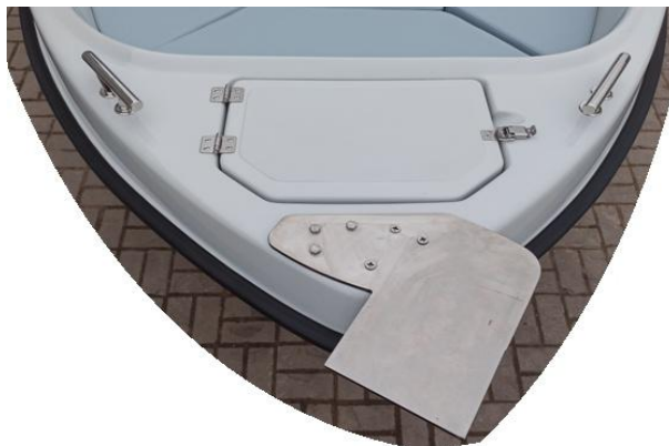
podstawka pod silnik elektryczny na dziobie
