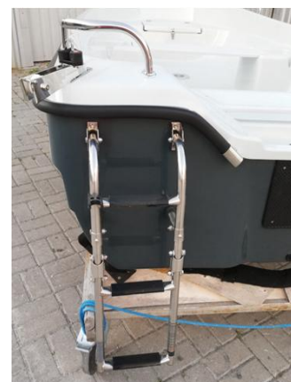
* drabinka 3-stopniowa rozkładana INOX, montowana z lewej
