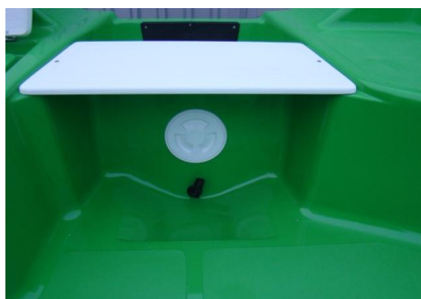
* odpływ z pokładu za pomocą kanału
