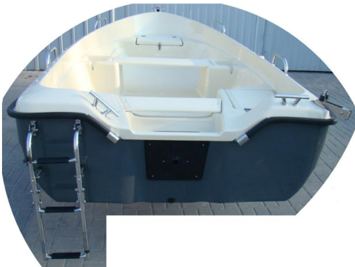
* drabinka 3-stopniowa rozkładana INOX, montowana z lewej strony
