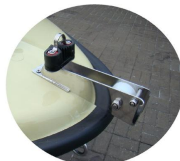
* winda kotwiczna (rolka) INOX mała z samozaciskiem i uchem INOX do ciężarka 5 kg
