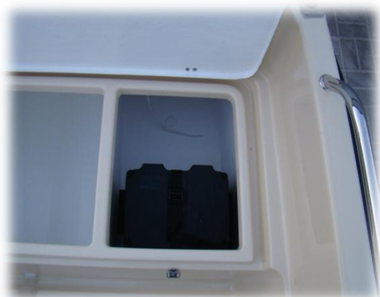
skrzynka akumulatorowa (w lewej tylnej bakiście)
