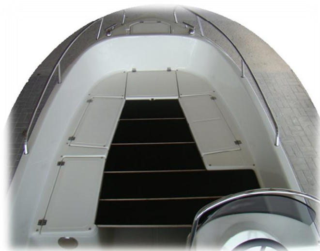
* pokład słoneczny/wędkarski 5 części ze sklejki wodoodpornej (konsola do tyłu)
