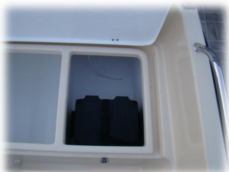
skrzynka akumulatorowa (w lewej tylnej bakiście)
