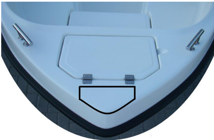
wzmocnienie dziobu pod silnik elektryczny lub winę
